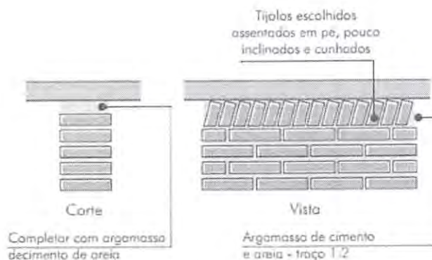
Imagem 3- Cunhamento de alvenaria
