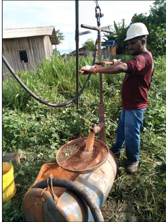
EXECUÇÃO DA SONDAGEM A PERCUSSÃO – SPT-01
